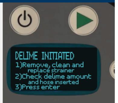
**7 INSPECCIONE EL INTERIOR DE LA MÁQUINA.** De ser necesario, puede iniciarse otro ciclo de eliminación del sarro. Para ello, acceda al **Manager Programming Mode (Modo de programación de administrador)** (repita los pasos 1 a 4 anteriores).
