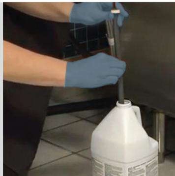
**4 ⚠ INHABILITE EL SISTEMA QUÍMICO DEL ALIMENTADOR DE DETERGENTE** según la recomendación del fabricante del químico. Esto evitará que se agregue detergente durante la operación de eliminación de sarro.
