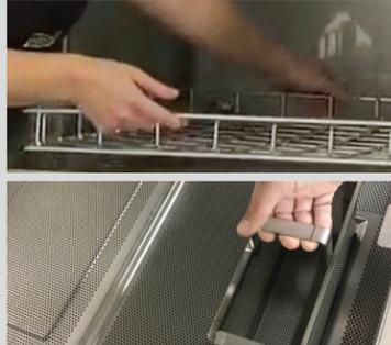
**2 VUELVA A INSTALAR LAS PANTALLAS DE FILTRO LIMPIAS,** la bandeja de residuos y el bastidor en la máquina, y cierre la puerta.
